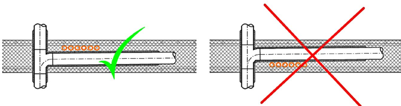
**[FIG. 2]** Incroci con tubo di scarico (immagine: Alco Haustechnik AG).
